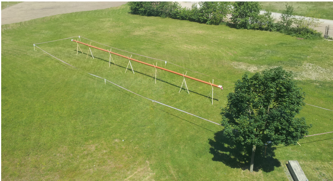
Abb. 5.8: Aufgebaute Bahn im Freifeld zur Sicherstellung einer möglichst ungestörten Messung.
